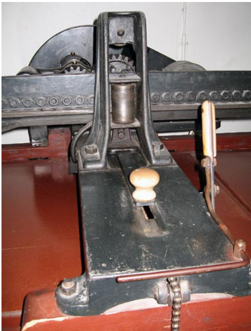
Stenmangeln består av två tunga kalkstenshällar. Mellan dem finns trärullar att placera lakan och annat runt. Nedan till vänster ses manöverpanelen då ena eller andra sidan ska lyftas.
