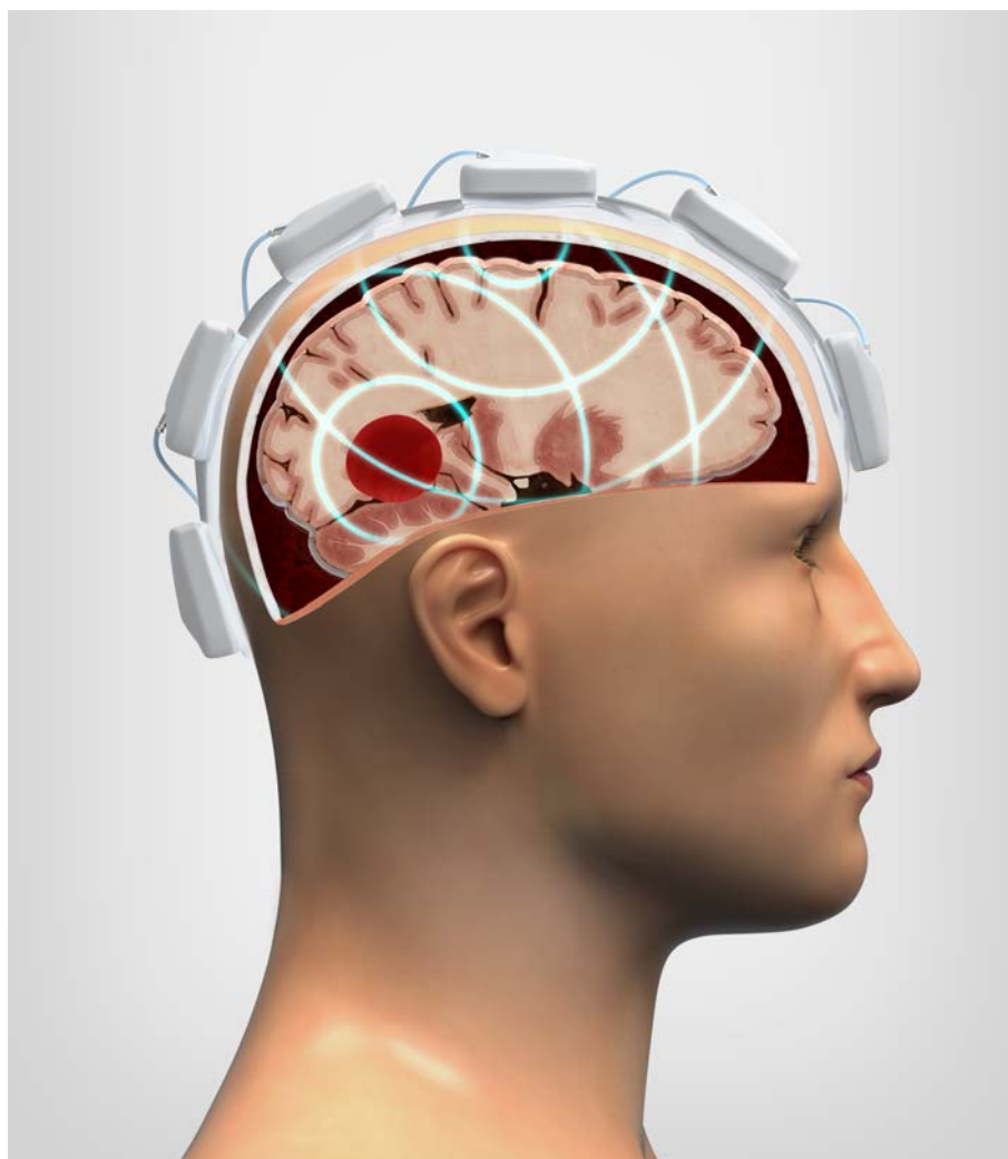
Figur 5.3 – Med mikrovågssensorer i en hjälm har Strokefinder (Medfield Diagnostics AB) kunnat detektera stroke och blödningar med hög säkerhet utan behov av datortomografi (Grafik: Boid).
