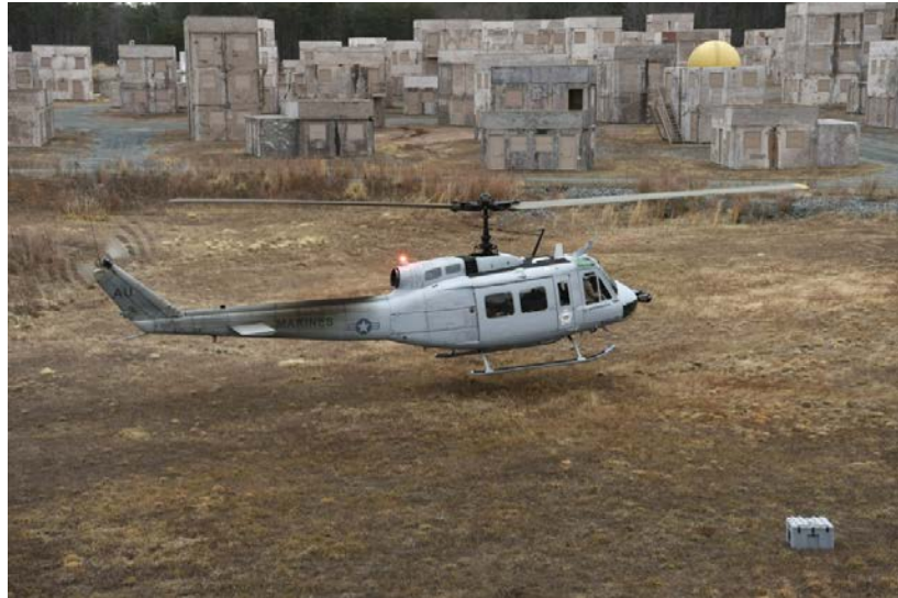
Figur 4.3 – UH-1 Huey som konverterats till att bli en autonom UAV med hjälp av AACUS sensorer och autonomimjukvara (Foto: Autonom landning under flygförsök som genomfördes 2017 på Marinkårsbasen i Quantico. John F. Williams, US Navy, public domain).
