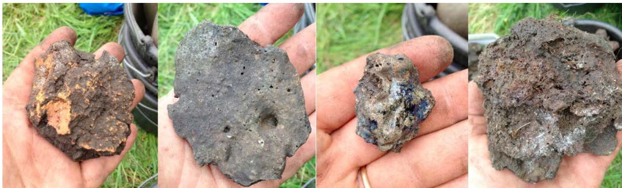
Fig. 55. Slagg från schakt 7, f. h. t. v., 1) del av ässja, 2) andra sidan föregående objekt, 3) förglasad del från ässja, 4) kalottslag. Foto: Julius Lundin
