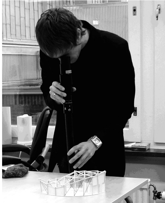
FIGUR 17.3 En skalmodell betraktas genom ett endoskop.
